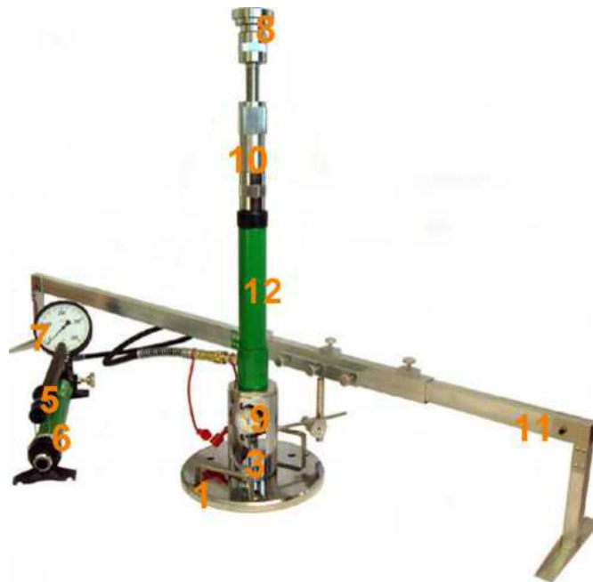
Rys. 1.2 Aparatura VSS z jednopunktowym pomiarem przemieszczenia płyty
